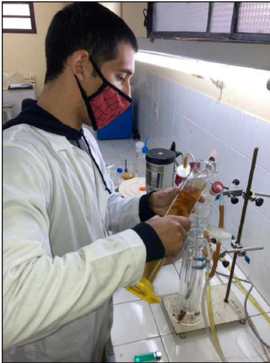
Figura C1. Preparación de medio en el reactor air-lift.
